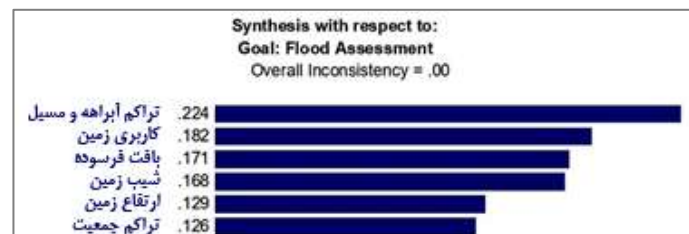
شکل ۳ - نتایج ضرائب پیش‌فرض معیارهای شش‌گانه ارزیابی آسیب‌پذیری ناشی از سیلاب، حاصل از روش تحلیلی سلسله‌مراتبی Figure 3. Default weight of the six indicators of flood vulnerability assessment tool
