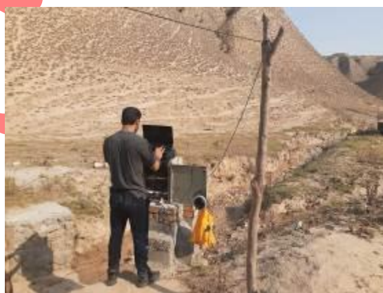
شکل ۱۲- نمونه سیلاب برداشت شده توسط دستگاه پایش خودکار رواناب و رسوب Figure 12- The flood sample taken by the automatic runoff and sediment monitoring device
