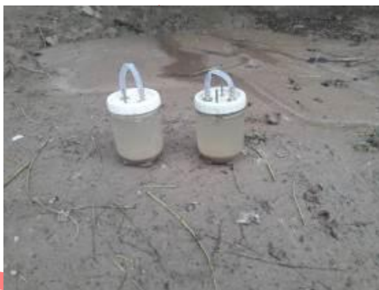
شکل ۱۲- نمونه سیلاب برداشت شده توسط دستگاه پایش خودکار رواناب و رسوب Figure 12- The flood sample taken by the automatic runoff and sediment monitoring device
