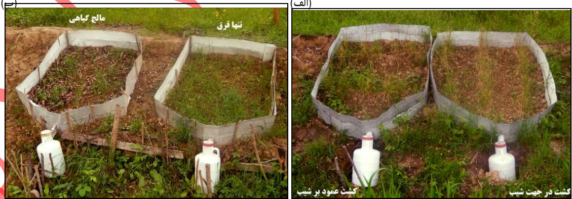
شکل ۲- تیمارهای مختلف پلات‌های زوجی الف) تیمار پوشش مرتعی ب) تیمار شخم و لاش‌برگ پ) تیمار کشت نواری و کشت عمود بر جهت شیب؛ ت) تیمار فرق و مالچ گیاهی (لاش‌برگ و سرشاخه خردشده) Figure 2. Different treatments of coupled plots A) treatment of rangeland cover B) treatment of plow and leaves C) Treatment of strip cultivation and vertical cultivation in the direction of the slope, D) Treatment of grass and mulch (chopped litter and branches)
