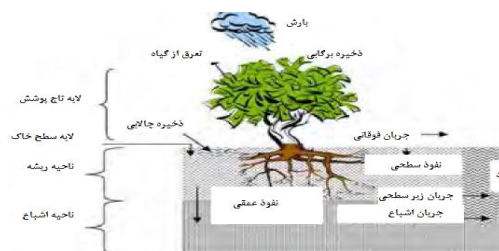
شکل ۶- اجزای سیستم هیدرولوژیک حوزه در مدل WetSpa Figure 6. The components of the hydrological system in the WetSpa model
