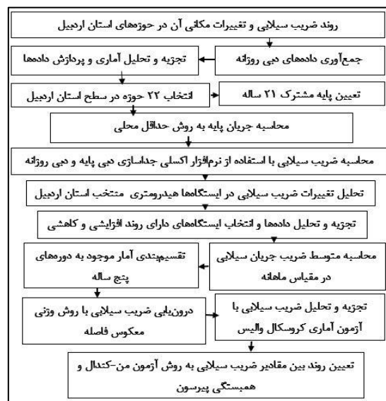
شکل ۲- نمودار جریانی تعیین روند ضریب سیلابی در ایستگاه‌های هیدرومتری استان اردبیل Figure 2. Stage diagram of flood coefficient determination at hydrometric stations of Ardabil province
