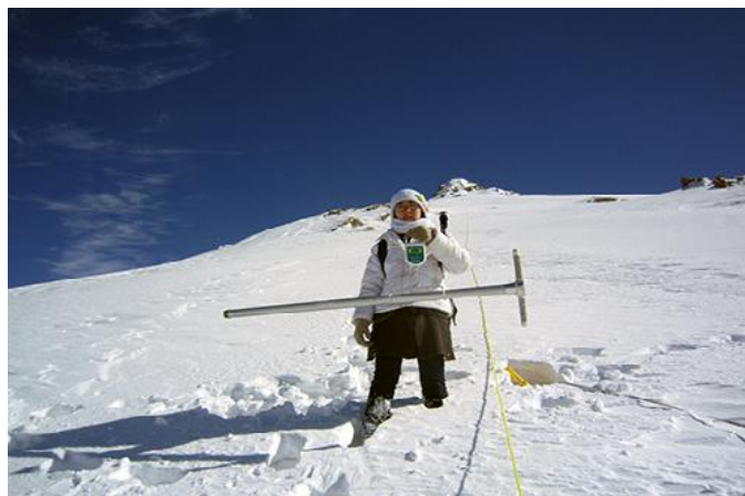
شکل ۲- انجام نمونه برداری با استفاده از نمونه بردار مدل مونت رز.
