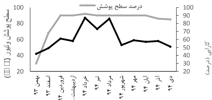
شکل ۱۱- تغییرات کارایی نوارهای حائل گیاهی حاوی وتیور و درصد سطح پوشش گیاهی وتیور در طول دوره آزمایش Figure 11. Variations of the efficiency of vetiver buffer strips and vetiver grass vegetation cover during the study period
