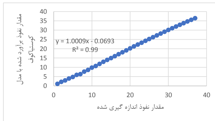
شکل ۵- مقدار نفوذ تجمعی اندازه‌گیری‌شده و برآوردی با فرمول کوستیاکوف در کاربری کشاورزی در بافت سیلتی کلی لوم Figure 5. Measured and estimated cumulative infiltration amount with Kostiakov model in Agricultural land use in Silty clay loam texture
