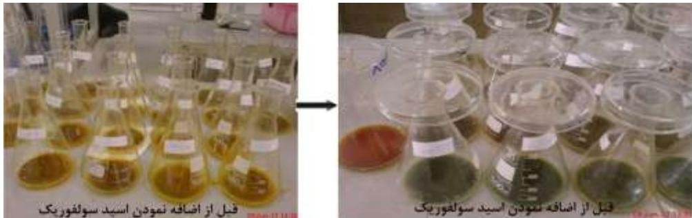
شکل ۵- تعییر رنگ نمونه‌ها قبل و بعد از اضافه شدن اسید سولفوریک جهت تعیین درصد مواد الی خاک
