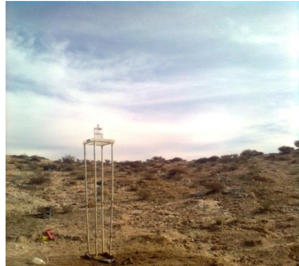
(ب) (الف) شکل ۳- نمایی کلی از شبیه‌ساز کامفورست اصلاح شده در ارتفاع ۲۰۰ سانتی‌متری Figure 2. Total view of the kamphorst rain simulator modified in height 200 cm
