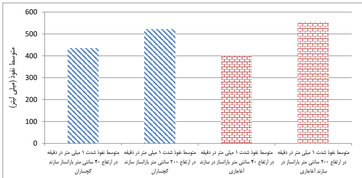
شکل ۸- مقایسه متوسط میزان نفوذپذیری در ارتفاع‌های مختلف شبیه‌ساز باران و در شدت ۱ میلی‌متر در دقیقه در کاربری مرتع سازندهای گچساران و آغاچاری
