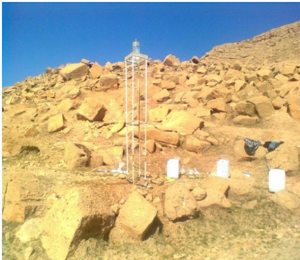
(ب) (الف) شکل ۳- نمایی کلی از شبیه‌ساز کامفورست اصلاح شده در ارتفاع ۲۰۰ سانتی‌متری Figure 2. Total view of the kamphorst rain simulator modified in height 200 cm
