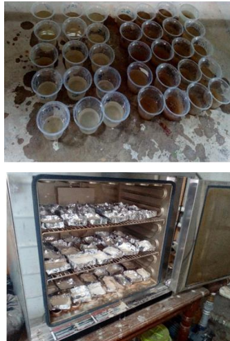
شکل ۲- برجاگذاری نمونه‌های رواناب و رسوب به مدت ۲۴ ساعت (بالا) و قرار دادن نمونه‌های رسوب تغلیظ شده در آون با دمای ۱۰۵ درجه سانتی‌گراد به مدت ۲۴ ساعت (پایین)
