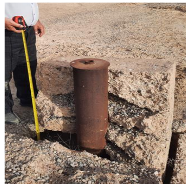
شکل ۶- (الف) فرونشست اتفاق افتاده در محدوده دشت دامغان، (ب) ترک در سطح زمین، و (ج) فرونشست اطراف پیزومتر مشاهداتی Figure 6. (a) Subsidence occurred in Damghan plain, (b) cracks on the ground surface, and (c) subsidence around observational piezometer.
