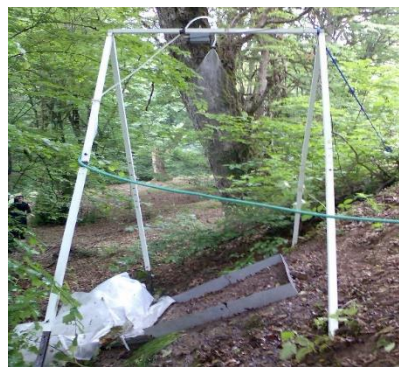
شکل ۲- استقرار باران‌ساز بر روی ترانشه خاکریزی جاده جنگلی و عبور رواناب از کاغذ صافی
