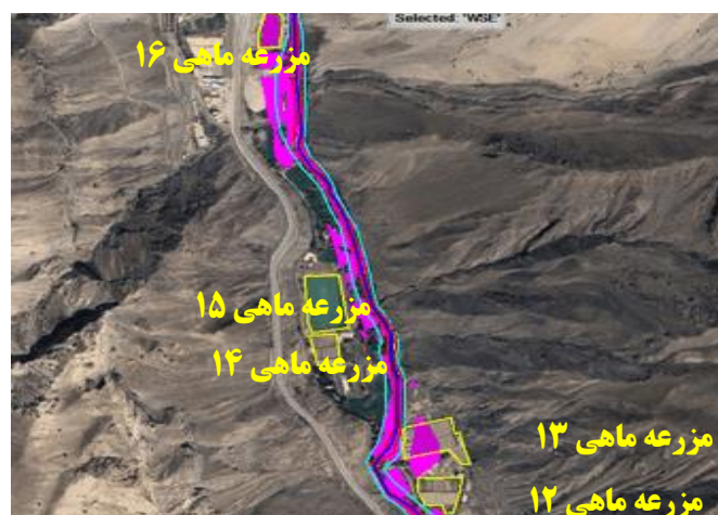
شکل ۱۳- تاثیر پهنه سیلاب ۱۰۰ ساله بر روی مزارع ماهی حاشیه رودخانه هراز- بازه سوم
