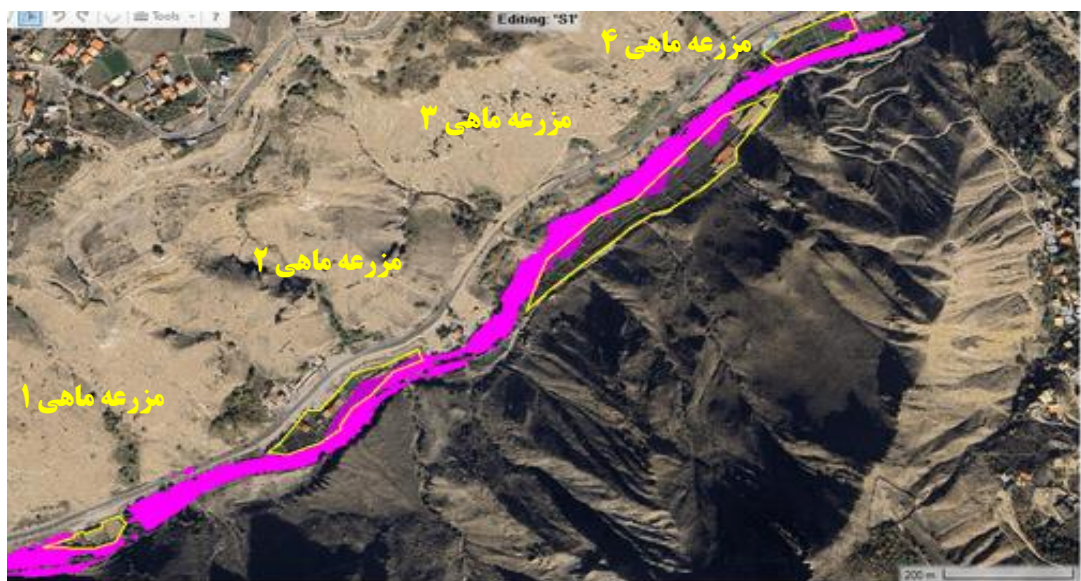
شکل ۱۱- تاثیر پهنه سیلاب ۱۰۰ ساله بر روی مزارع ماهی حاشیه رودخانه هراز- بازه اول Figure 11. The impact of the 100-year floodplain on fish farms along the Haraz River – the first period
