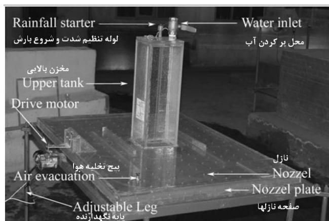
شکل ۵- بخش‌های تشکیل‌دهنده دستگاه شبیه ساز باران (وهابی و نیک کامی، ۱۳۸۷)
