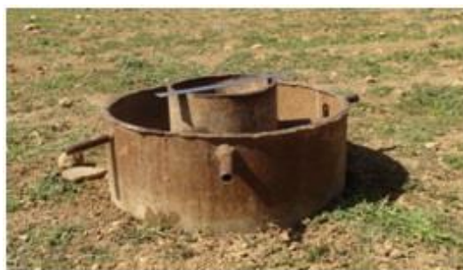
شکل ۲- استوانه‌های مضاعف نصب شده در محل تحقیق.
