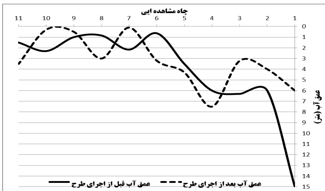
شکل ۸- مقایسه عمق آب قبل و بعد از اجرای طرح شبکه آبیاری و زهکشی البرز در شرایط بهینه برداشت از آب زیرزمینی
