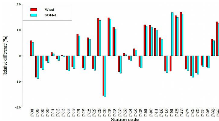
شکل ۱۱- مقایسه‌ی برآوردهای سیلاب با دوره بازگشت ده سال برای ایستگاه‌های مورد مطالعه Figure 11. Comparison of the flood estimates with ten-year return period for the interested stations
