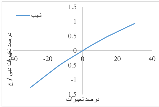
شکل ۴- درصد تغییرات شیب و تأثیر آن بر دبی اوج بر حسب درصد Figure 4. The Effective of the Slope Variation Percentage on the Peak flow
