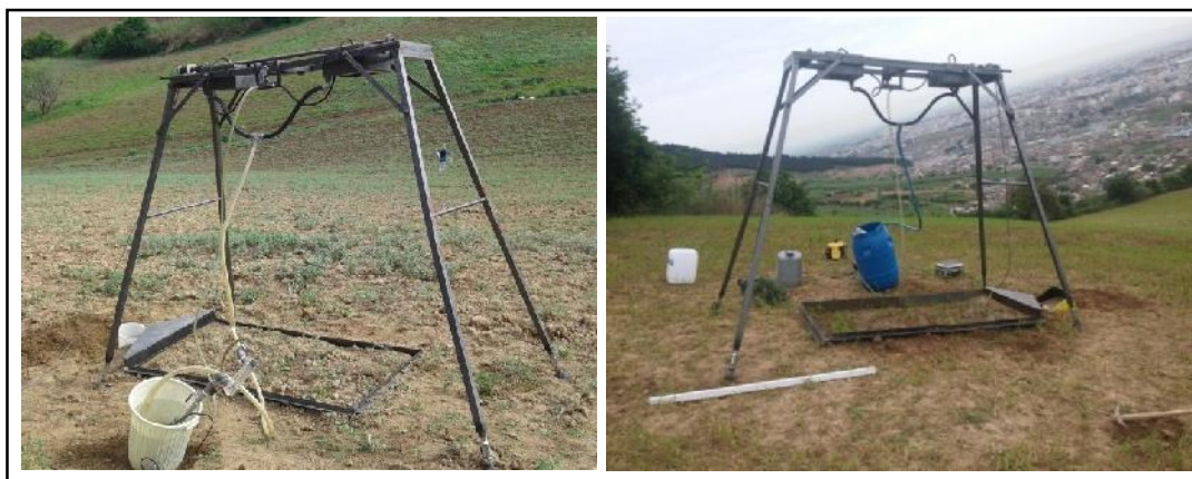
شکل ۲- اجرای شبیه‌ساز باران در حوزه مورد مطالعه Figure 2. Rainfall simulation in study area
