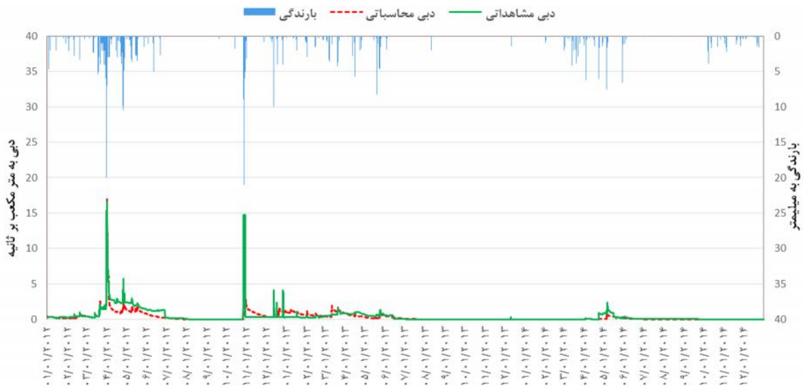
شکل ۶- هیدروگراف محاسباتی و مشاهداتی ساعتی در دوره اعتبارسنجی (ساعتی) Figure 6. Computational and observational hydrograph in Validation Period (hourly)
