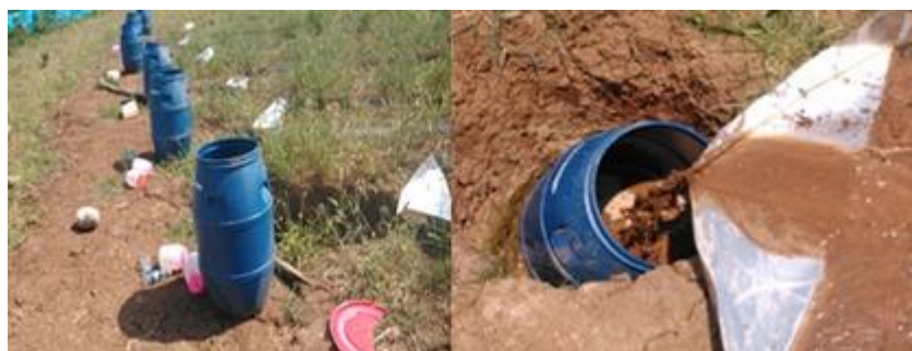
شکل ۳- برداشت نمونه‌های آب جمع‌آوری شده در مخازن انتهای کرت‌های آزمایشی Figure 3. Water sampling from the collected water in the downslope reservoirs
