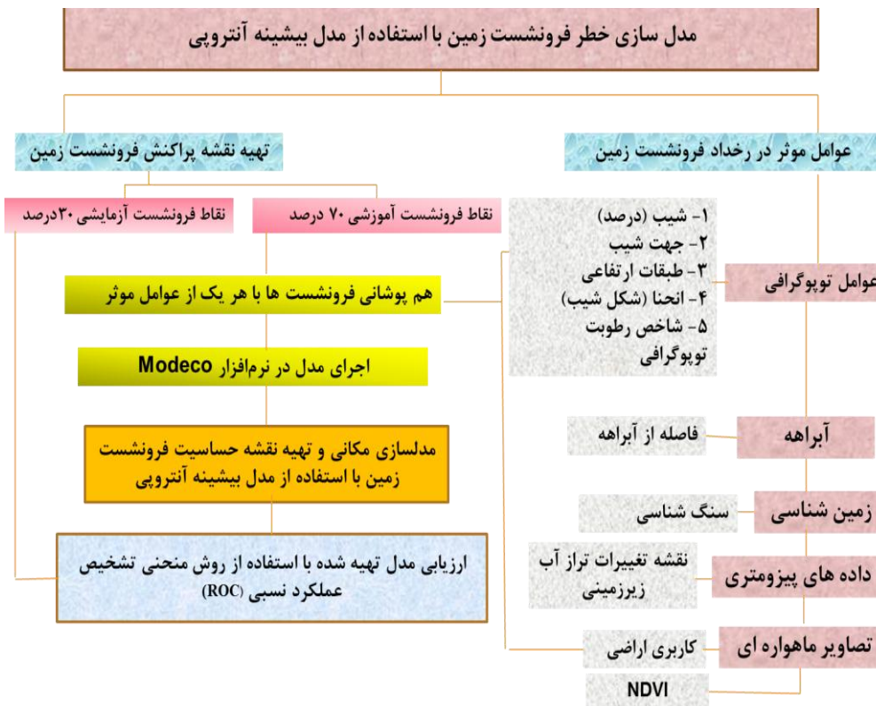
شکل ۲- نمودار جریان مراحل تهیه نقشه حساسیت فرونشست زمین Figure 2. Flowchart of land-subsidence susceptibility mapping steps
