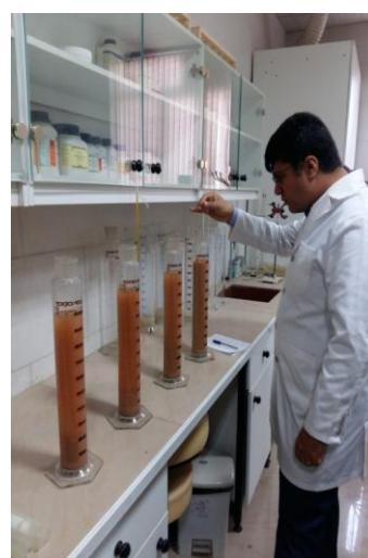
شکل ۵- اندازه‌گیری بافت خاک به روش هیدرومتری (مهر ۱۳۹۶)
