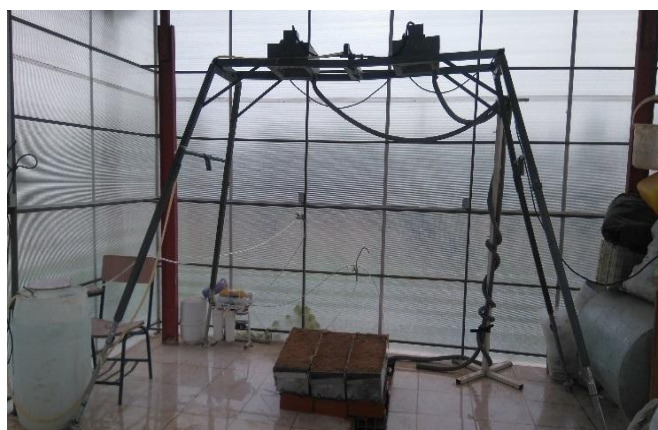
شکل ۱- نمایی از شبیه‌ساز باران در شرایط آزمایشگاهی Figure 1. View of rainfall simulator in laboratory conditions
