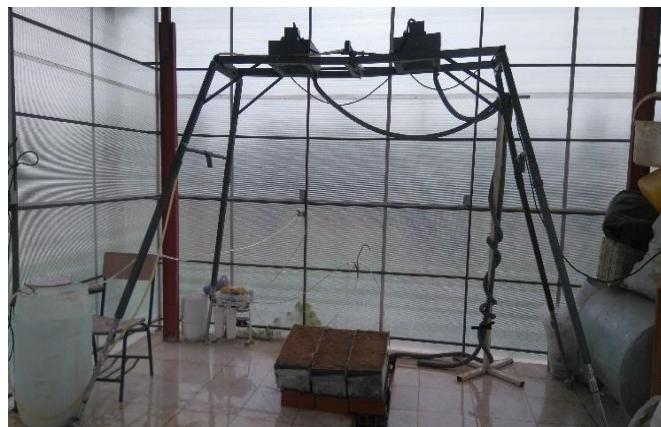
شکل ۱- نمایی از شبیه ساز باران در شرایط آزمایشگاهی
