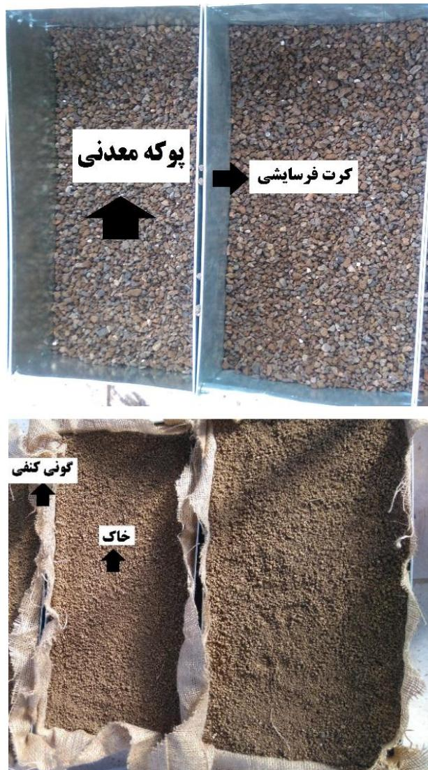
شکل ۲- نمایی از قرارگیری پوکه معدنی (بالا) و گونی گنبی (پایین) در کرتهای
