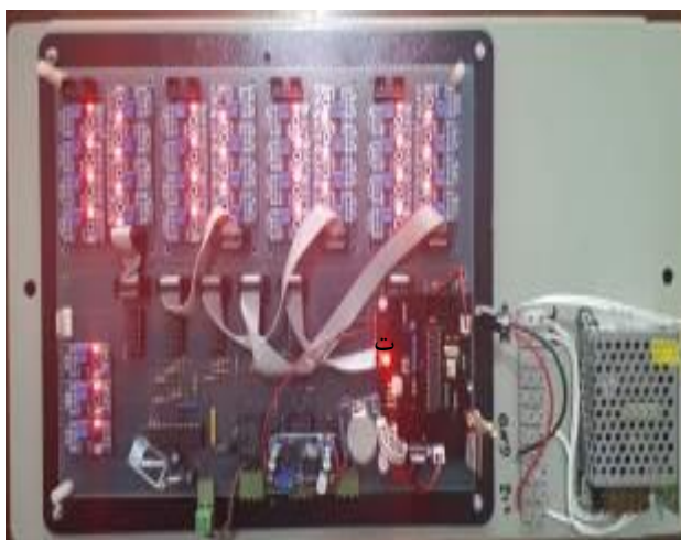
شکل ۲- اجزای دستگاه پایش خودکار رواناب و رسوب: الف) تصویر شماتیکی از محل نصب نمونه‌بردار طراحی شده در خروجی منطقه مورد مطالعه، ب) تصویر شماتیکی از فضای داخلی جعبه محافظ تهیه شده برای استقرار برد الکترونیکی، پمپ خلأ و ظروف نمونه‌برداری، پ) جعبه محافظ دستگاه و لوله محافظ سنسورهای اندازه‌گیری ارتفاع رواناب، ت) برد الکترونیکی طراحی شده جهت نمونه‌برداری رواناب و رسوب
