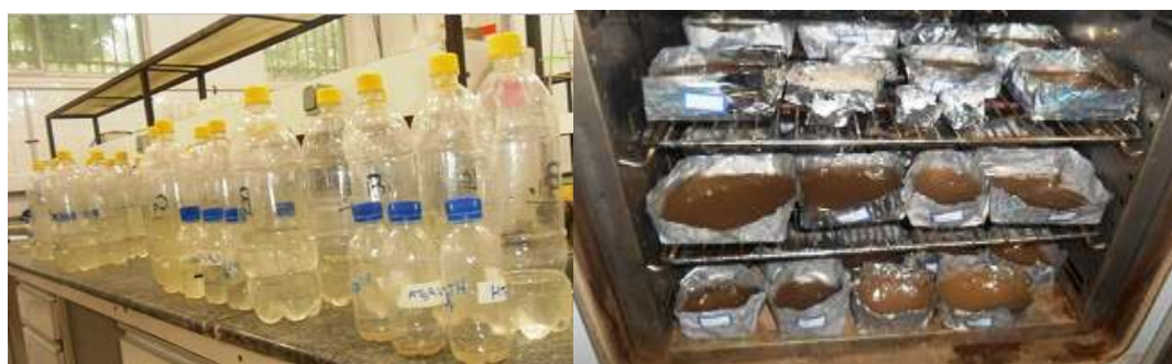
شکل ۳- نمونه‌های ارسالی به آزمایشگاه، الف و ب: نمونه‌های رواناب و رسوب Figure 3. Laboratory samples of runoff (right picture) and sediment (left picture)
