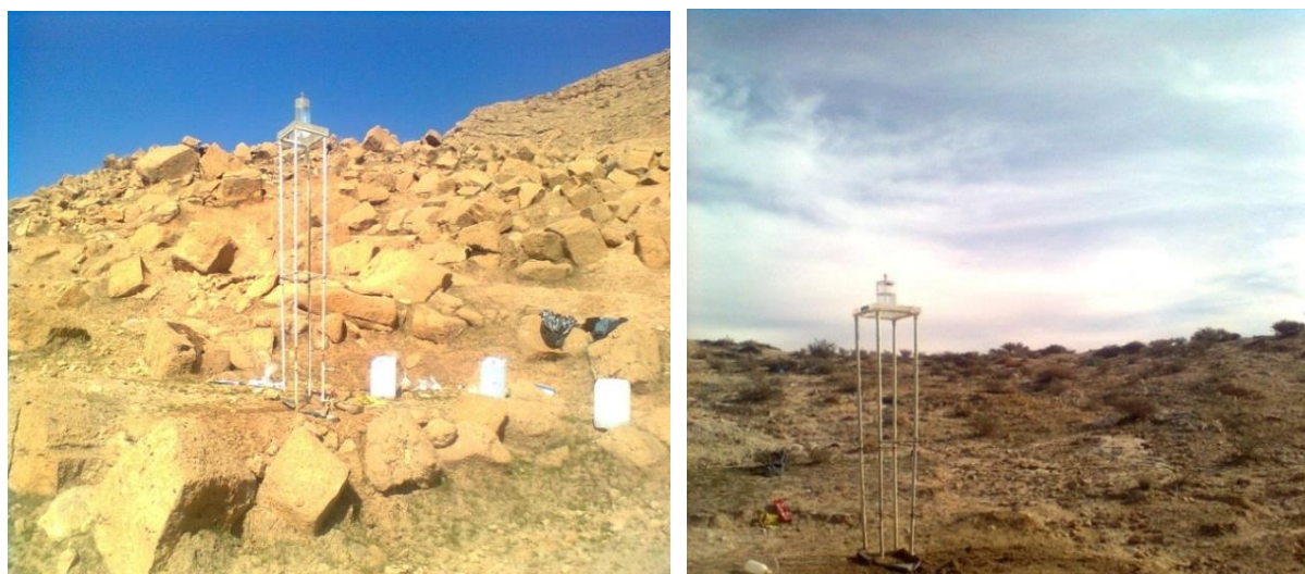
شکل ۳- نمایی کلی از شبیه‌ساز کامفورست اصلاح شده در ارتفاع ۲۰۰ سانتی‌متری Figure 2. Total view of the kamphorst rain simulator modified in height 200 cm
