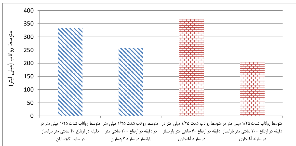
شکل ۷- مقایسه متوسط رواناب تولیدی در ارتفاع‌های مختلف شبیه‌ساز باران و در شدت ۱/۲۵ میلی‌متر در دقیقه در کاربری مرتع سازندهای گچساران و آغاچاری
