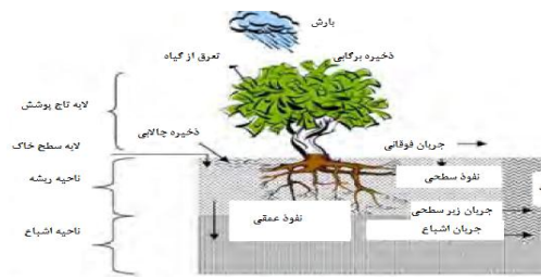
شکل ۶- اجزای سیستم هیدرولوژیک حوزه در مدل WetSpa Figure 6. The components of the hydrological system in the WetSpa model
