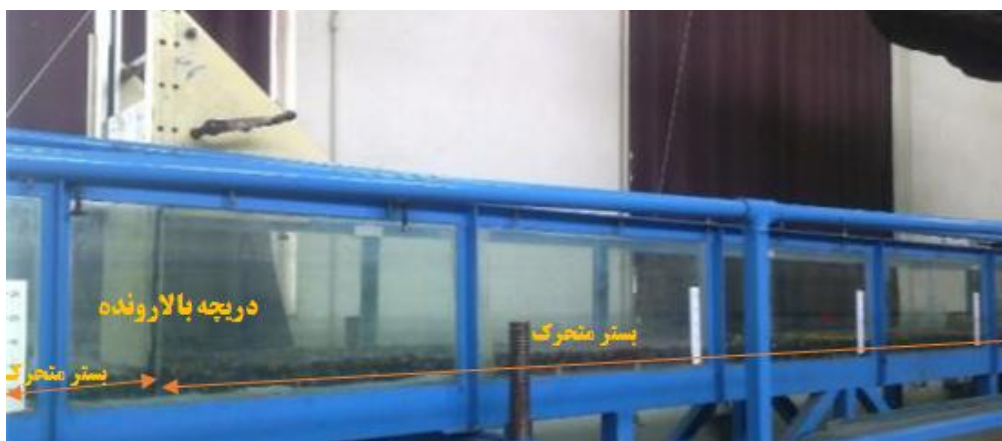
شکل ۱- موقعیت دریچه و بستر متحرک Figure 1. Location of gate and mobile bed
