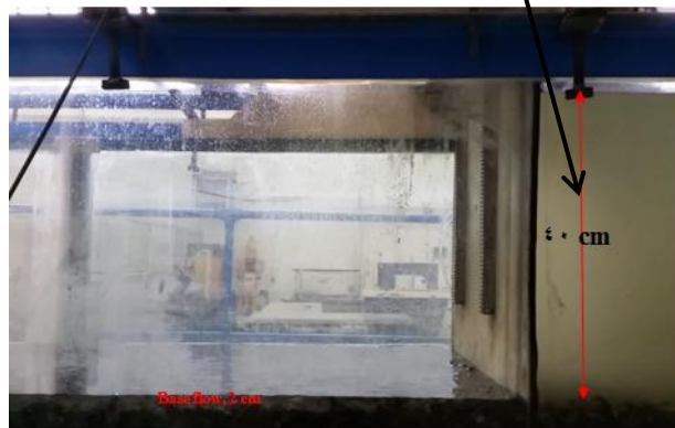
شکل ۳- ارتفاع آب ۴۰ سانتی متری پشت دریچه Figure 3. The 40 cm water level behind the gate
