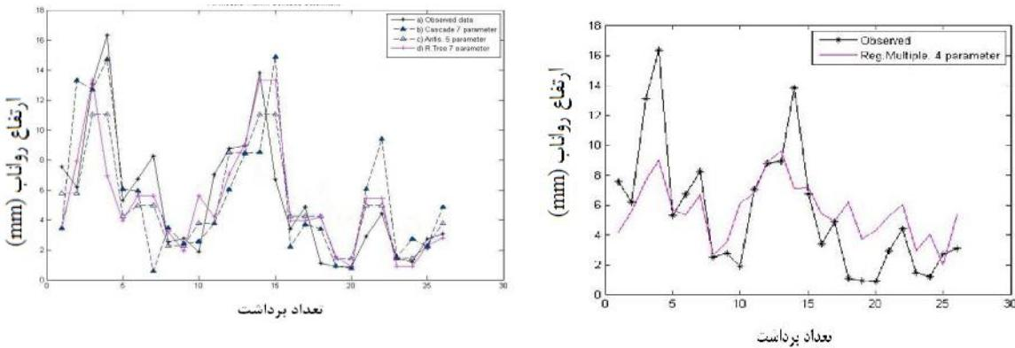
شکل ۳- نمودار مقایسه‌ای داده‌های برآورده مدل رگرسیون چندگانه با میزان رواناب مشاهده شده (شکل سمت راست) و نیز انواع ساختار شبکه عصبی پیش‌خور Cascade، شبکه فازی-عصبی ANFIS و مدل درخت تصمیم (شکل سمت چپ) با میزان رواناب مشاهده‌ای.
