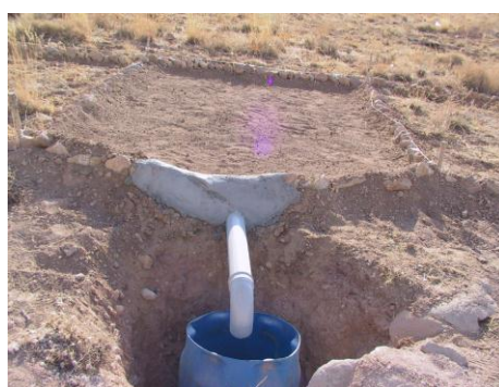
شکل ۴- تیمار جمع‌آوری پوشش گیاهی و سنگریزه سطح سامانه (زمین تمیز شده) Figure 4. Vegetation and gravel collection treatment (removed surface)
