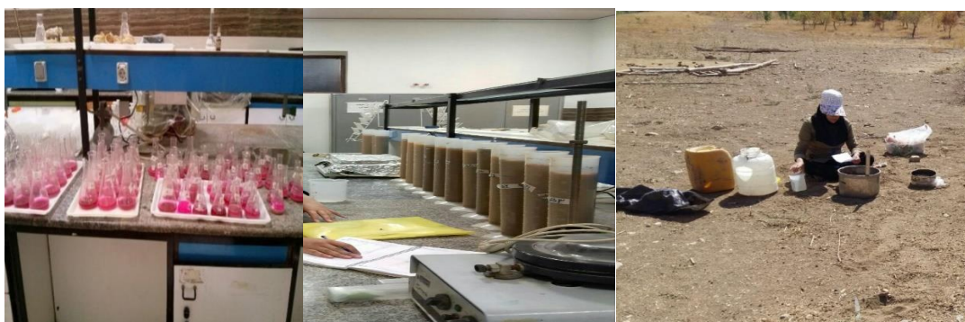
شکل ۲- اندازه‌گیری برخی ویژگی‌های آزمایشگاهی و نفوذ آب به خاک با استفاده از تک استوانه
