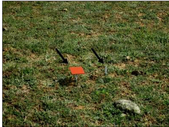
شکل ۲- تصویری از بین‌های فرسایشی استقرار یافته بر روی دامنه شیب دار مرتعی (سرپوش قرمز جهت شناسایی می‌باشد) Figure 2. A view of the palced erosion pins on the rangeland hillslope (red cap for identification)
