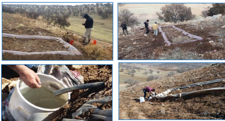
شکل ۳- پلات‌های احداث شده و مراحل اندازه‌گیری حجم رواناب در حوزه کل شیخی از سرشاخه‌های سد پارسیان در شهرستان ممسنی Figure 3. Constructed plots and the stages of measuring the runoff volume in the Sheikhi area of the main branches of the Parsian dam in Mamsani City
