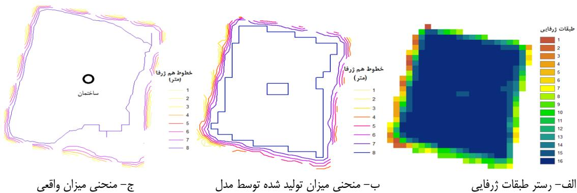
شکل ۸- مقایسه خطوط منحنی میزان واقعی و تولید شده از طبقه‌بندی ژرفایی تصویر باند ۴ آب‌بندان دشت‌ناز
