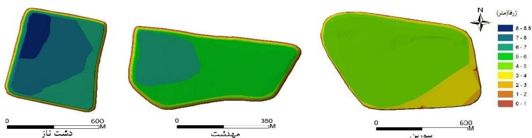
شکل ۳- نقشه TIN ژرفای اندازه‌گیری شده آببندان‌های مهدشت و سورین و دشت‌ناز
