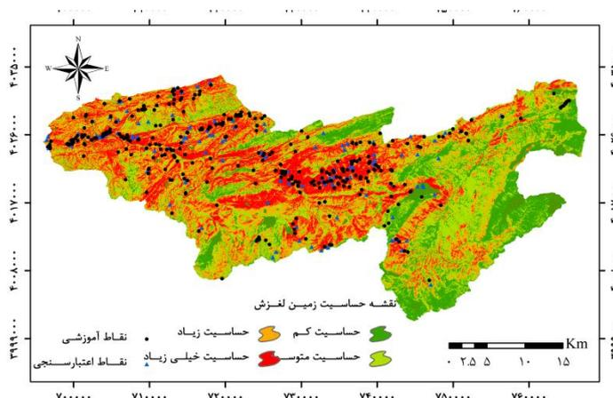
شکل ۳- نقشه حساسیت زمین‌لغزش حوزه آبخیز چهاردانگه با استفاده از مدل رگرسیون لجستیک
