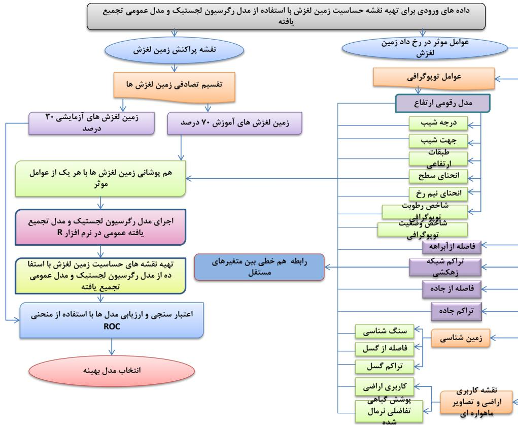
شکل ۲- نمودار جریان‌ی تهیه نقشه حساسیت زمین لغزش با استفاده از مدل‌های عمومی تجمیع یافته و رگرسیون لجستیک
