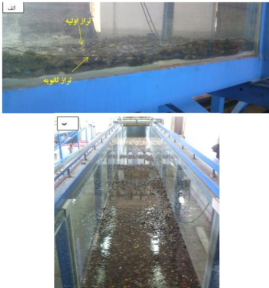
شکل ۶- تغییرات ریخت‌شناسی بستر بعد از آزمایش: الف) در راستای عرضی فلووم و ب) در راستای طولی فلووم Figure 6. Bed evolution after each experiment: a. at transverse direction and b. longitudinal direction of the Flume
