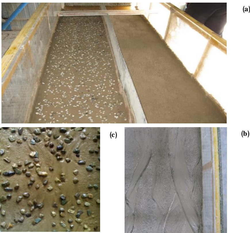
شکل ۱- (a) نمایی از فلوم مورد استفاده، (b) خاک بدون پوشش و (c) خاک ۳۰ درصد پوشش سنگ‌ریزه سطحی Figure 1. a) A schematic of flume used b) Soil with 0% surface cover c) Soil with 30% surface rock fragment cover
