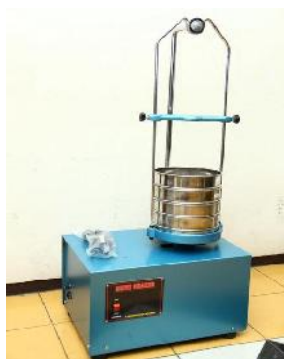
شکل ۴- انجام آزمایش دانه‌بندی با الک استاندارد (آزمایشگاه خاک، مرکز تحقیقات کشاورزی خراسان) Figure 4. Soil granularity test with standard shaker laboratory (Soil laboratory of Khorasan Agricultural Research Center)
