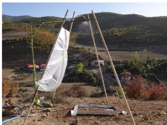
شکل ۳- نمایی از شبیه‌ساز باران مورد استفاده در شرایط صحرایی
